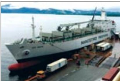
Abbildung 6: Das Kühlschiff „Ice Rose“ (ex „Reefer Jambu“ Bj. 1985) hat eine Kühlraumkapazität von 668.000 cbft.
