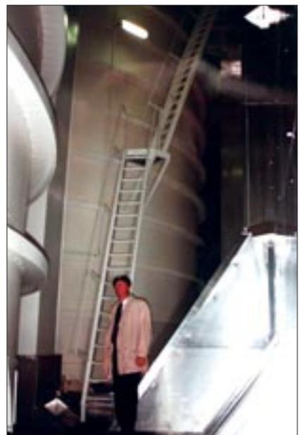
Abbildung 8: Safttanks im Kühlladeraum eines Fruchtsafttankers. (Foto Dr. Hochhaus)
