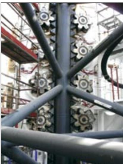
Abbildung 6: Innovation, der Beintrieb mit Zahnrädern, die auf Zahnstangen wirken.
