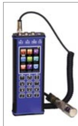
Handgerät verbundene Sensor mithilfe eines Magnetkopfs oder eines Gewindes an der Anlage angeschlossen. Dabei ermittelt das Vibration Meter Ma-
