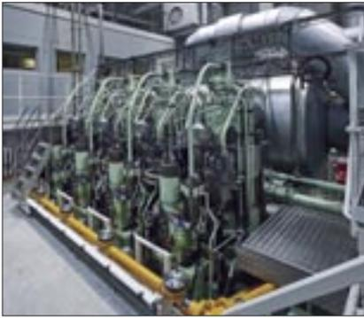
Die neue Variante der Zweitaktmotoren von MAN Energy Solutions, der auch mit Autogas zu betreibende Motortyp ME-LGIP; wurde Anfang September 2018 auf dem Prüfstand im Forschungszentrum des Unternehmens in Kopenhagen vorgeführt Foto: MAN
