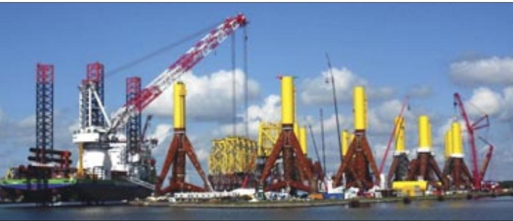
Abbildung 1: Errichterschiff Innovation beim Laden in Bremerhaven.
