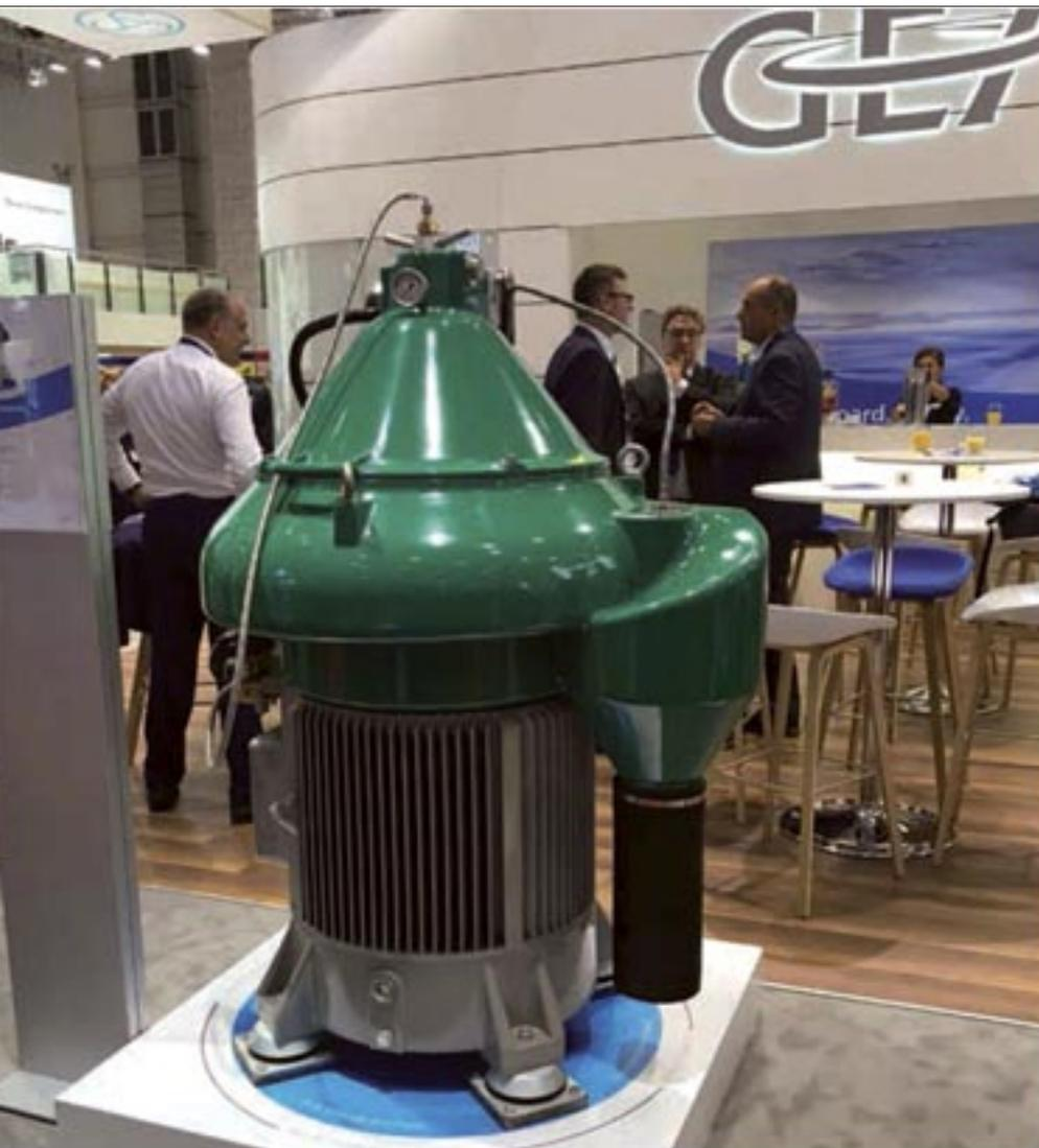
Der neue GEA marine Separator mit integriertem Direktantrieb wurde auf der SMM vorgestellt.
