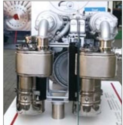
Auch die Motoren des Geschäftsbereichs MAN Engines von MAN Truck & Bus sind jetzt voll zertifiziert mit SCR-Anlagen für den Antrieb von Arbeitsbooten mit Leistungen bis zu rund 1200 kW (IMO Stufe 3) lieferbar. Foto: Reuß
