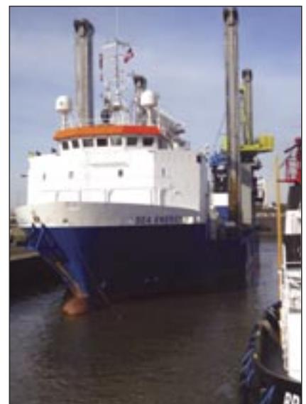
Abbildung 4: „Sea Energy“, ein zum Errichterschiff ungebauter Frachter.
