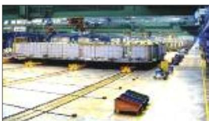
Abbildung 11: Vorfertigung der Sektionen in der Meyer Werft. (Foto: Meyer Werft)
