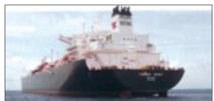
Die „Torben Spirit“, ein Teekay 173.400-m<sup>3</sup>-LNG-Tanker mit 2 x 5G70ME-GI-Motoren.
