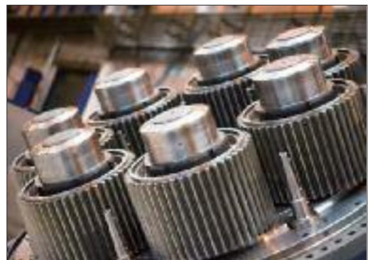
In den Turbinen von ANDRITZ HYDRO kommen auch diverse maßgeschneiderte Kegelrollenlager von SKF zum Einsatz; so z.B. auf der Hauptwelle, in der Blattverstellung und nicht zuletzt im ebenso kompakten wie robusten „Flex Pin“-Getriebe von Wikov MGI.
