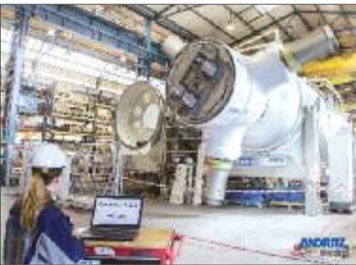
Im Gezeitenstrom müssen die riesigen 1,5-Megawatt-Turbinen u.a. Kräften widerstehen, die an Land bei einem Orkan von etwa 350 km/h entständen. (Bilder: ANDRITZ HYDRO)
