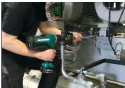
Kompakt und uneingeschränkt mobil: Die neue mobile Montagemaschine im Stauff Press-Programm eignet sich bestens für den Einsatz vor Ort – zum Beispiel im Schiffbau.
