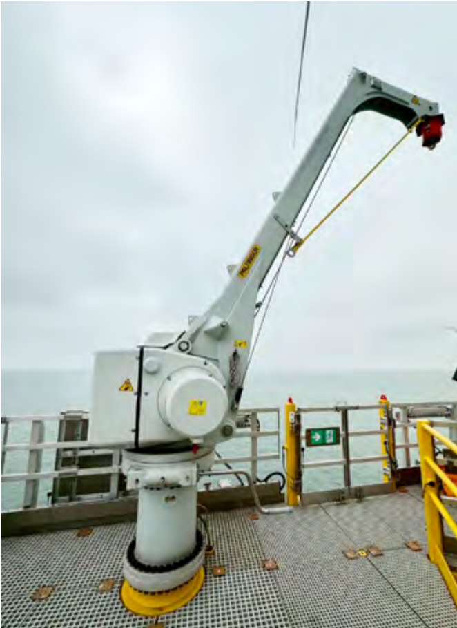
Oben: Der PF120 ist ein Davit-Kran mit einem Plug-and-Play-System, das eine schnelle und unkomplizierte Installation ermöglicht und die Betriebskosten erheblich senkt. Foto: PALFINGER MARINE Unten: Kartenausschnitt der Ostsee. Der Windpark Baltica 2 liegt ca. 40 km nördlich von Leba (Polen).
