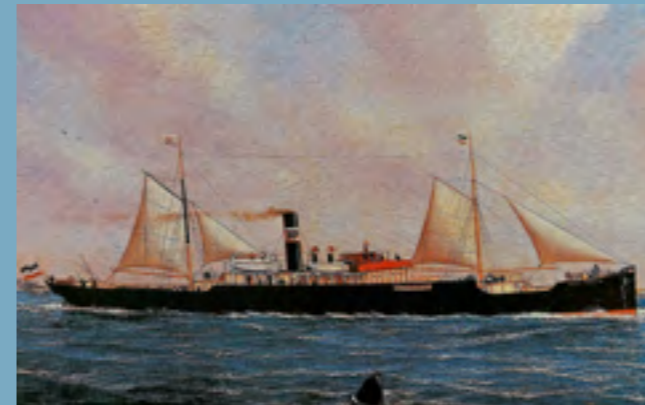
Der Frachtdampfer ANNA PODEUS (Baujahr 1897) hatte eine Länge von fast 75 Meter und war mit 1480 BRT vermessen. Die Hilfsbesegelung war noch bis 1898 aus Sicherheitsgründen Vorschrift. Den Antrieb lieferte eine Dreifach-Expansions-Maschine mit einer Leistung von 550 PSI
