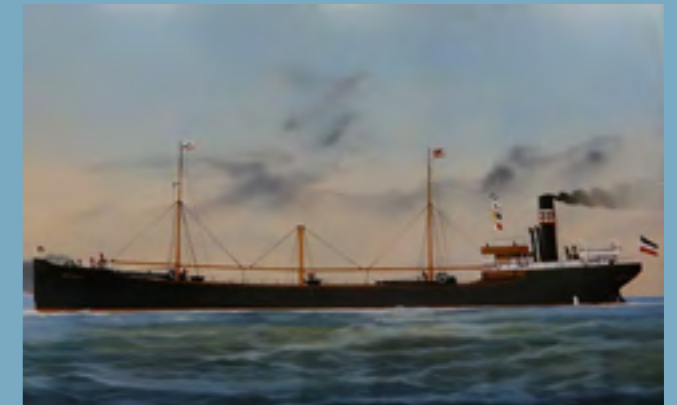
Die etwas über 90 Meter Länge und mit 2360 BRT vermessene WISMAR (2) wurde 1910 bei der Flensburger Schiffbau-Gesellschaft gebaut (Bau-Nr. 301). Antrieb: Dreifach-Expansions-Maschine mit 1400 PSI
