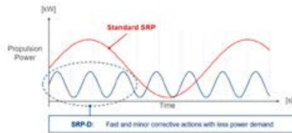
diese Optimierungen zu einer erhöhten Schubeffizienz während des DP-Betriebs. Je nach Ausrichtung des Ruderpropellers ergab die Simulation außerdem bis zu 50 Prozent weniger Schubverlust und weniger Restriktionen der zulässigen Azimutwinkel.
